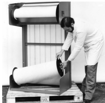
Il fondatore di CTS alle prese con il primo brevetto SIF: filtro rotativo a motorizzazione tubolare assiale, 1981
